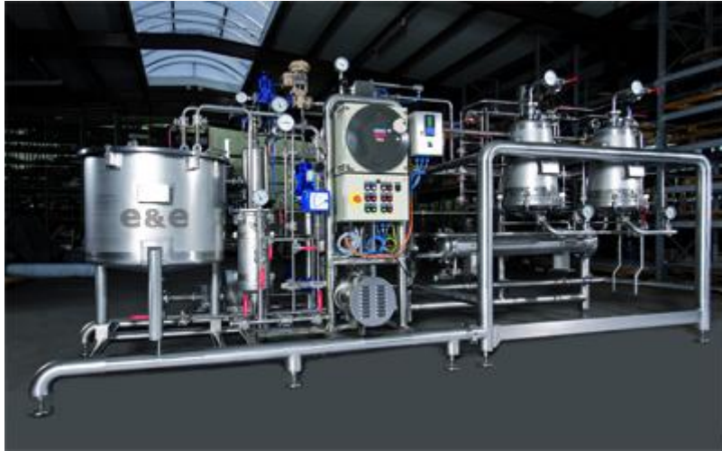
Exemple d'une unité de pilote d'extraction
