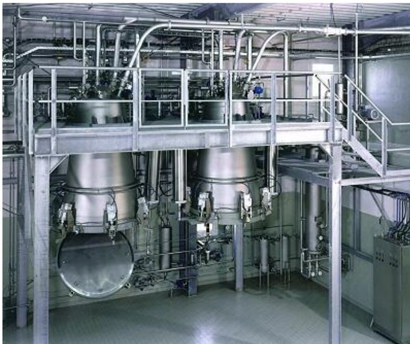
Exemple d'un système d'extraction par macération
