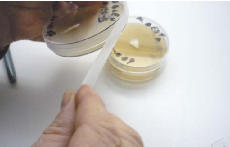
Fig.6 Tous les pétris sont identifiés et par la suite scellés au moyen de bandelettes de parafilm
