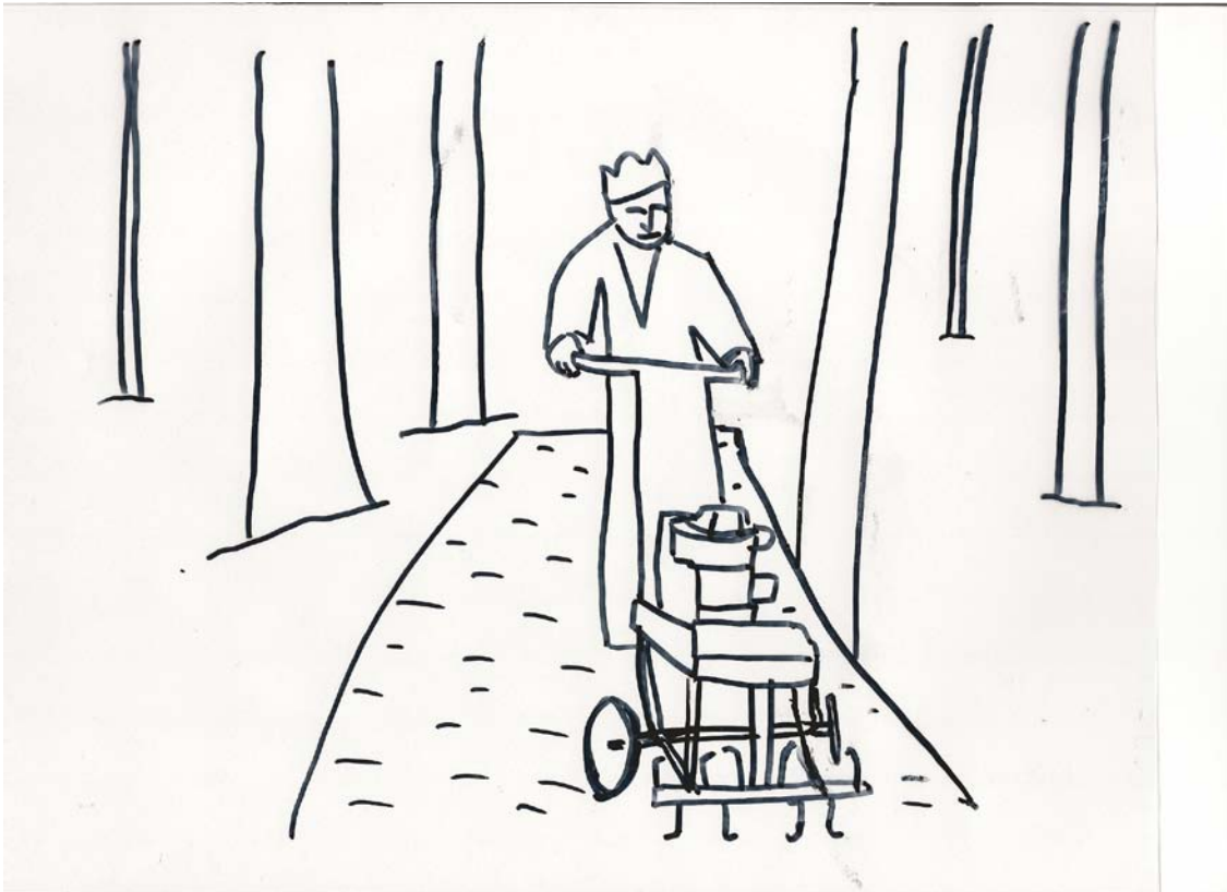
Fig.16 la chaux hydratée est mélangée aux débris broyés à l'aide d'un rotoculteur; au moins trois passages doivent être effectués.
