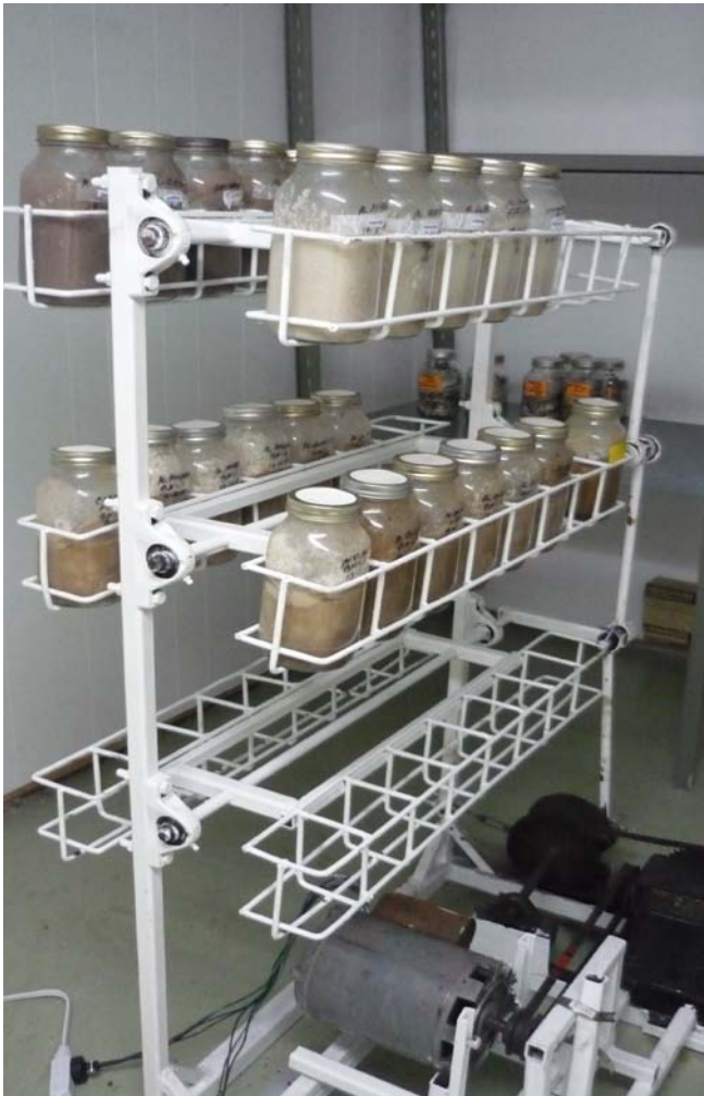
Fig.10 Les pots de culture sont placés sur un agitateur qui bascule de haut en bas conservant en rotation les milieux de culture dans les pots. Ainsi agités, les milieux de culture peuvent s'oxygéner et dégager les gaz produits par l'activité métabolique du mycélium.
