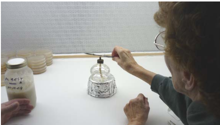
Fig.4 Les milieux gélosés et les pots de cultures mycéliennes liquides sont stérilisés au presto ou à l'autoclave. Par contre, avant et entre chaque opération, le petit outillage est stérilisé à la flamme d'un brûleur à alcool (scalpels, brucelles, pipettes, tiges de verre, etc.) Les plats de pétris et les seringues (à usage unique) sont pré-stérilisés par le fabricant.
